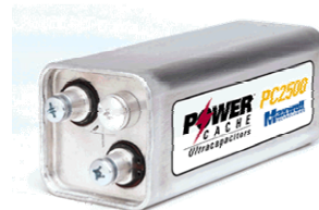
Fig. 3 - Super condensador com 2500 F (7200 J) (dim. : 160x60x60 mm e peso : 720 g)
